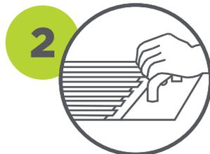
2 Con el lado liso de una llana metálica aplique una capa de adhesivo sobre la superficie haciendo presión. Aplique más material y peine con la parte dentada de la llana dejando líneas en un solo sentido. En la colocación de porcelanatos, grandes formatos, piso sobre piso y piezas en exteriores tráficos intensos, debe aplicarle adicionalmente adhesivo al reverso de cada pieza de manera uniforme, para lograr un contacto completo y máxima adherencia.
