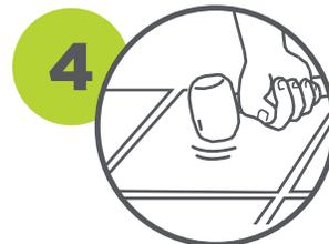
4 Golpee ligeramente las piezas con un mazo de goma para ajustar cada una en su lugar, hasta hundir una cuarta parte de la pieza en el adhesivo. Retire el exceso de adhesivo fresco de las boquillas.
