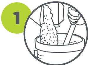
1 En 4.5-5 litros de agua limpia agregue gradualmente un saco de 20 kg o 0.45-0.5 litros para una bolsa de 2 Kg de Pegamix AMU mientras mezcla hasta obtener una pasta suave y sin grumos. Espere 10 minutos antes de usar la mezcla.
